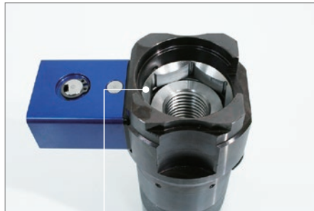
スプリング内蔵でナットへの位置合わせが不要
