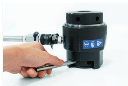
トミーバーでナットを回して締付け
