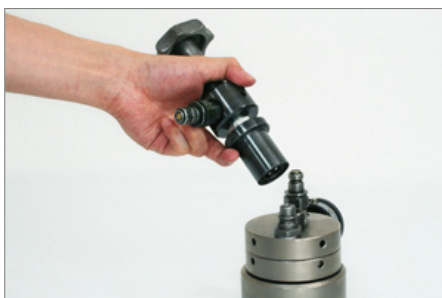
油圧アダプターを油圧ナットへ取り付け
