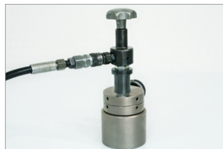
油圧ポンプと接続して油圧の封入、開封
